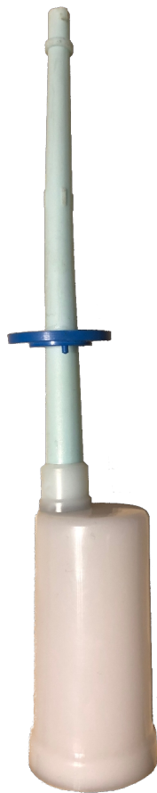
Rys. 4a. Przygotowana obudowa modułu do połączenia z grzybkiem.
