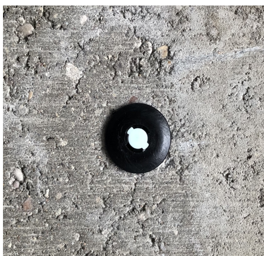
Rys. 7. Przed włożeniem anteny od dołu grzybka, założyć niebieskie zabezpieczenie modułu (Rys. 2) przekręcić i pociągnąć moduł w dół, aby antena była na płasko z grzybkiem.
