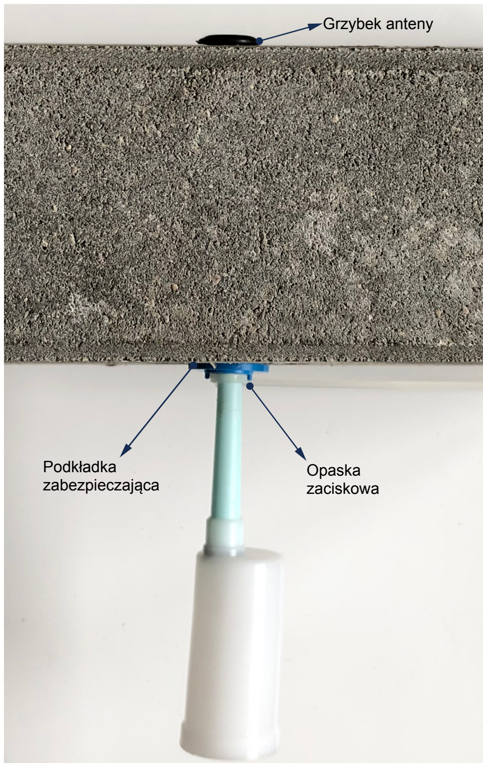
Rys. 8. Przesunąć zabezpieczenie na górę anteny, zacisnąć pod nim opaskę zaciskową tak, aby się nie przesunęła.
